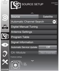
Select the line »Source« with »V« or »A« and press »OK« to confirm. Select the input source »Satellite« with »<«. »>«, »V« or »A« and press »OK« to con-
